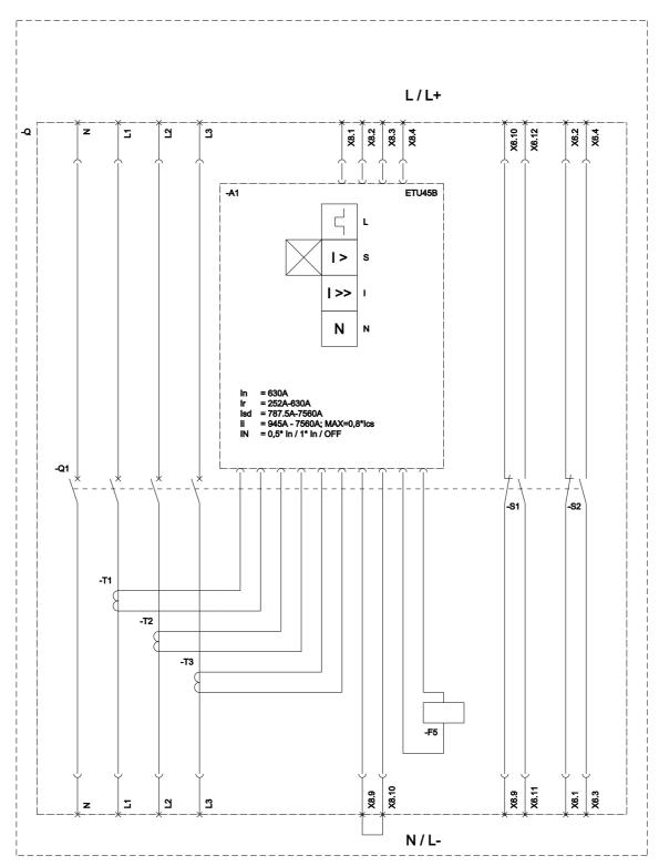
L (Long Time Delay / Überlastschutz); S (Short Time Delay / Kurzschlussschutz, kurzzeitverzögert); I (Instantaneous / Kurzschlussschutz, unverzögert) N (Neutral Protection / Neutralleiterschutz); F5 (Maglatch for trip unit / Auslösemagnet); S1 - S8 (Auxiliary switch / Hilfsschalter);
