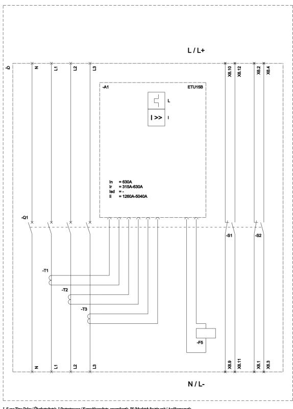
L (Long Time Delay / Überlastschutz); I (Instantaneous / Kurzschlussschutz, unverzögert); F5 (Maglatch for trip unit / Auslösemagnet); S1 - S8 (Auxiliary switch / Hilfsschalter);
