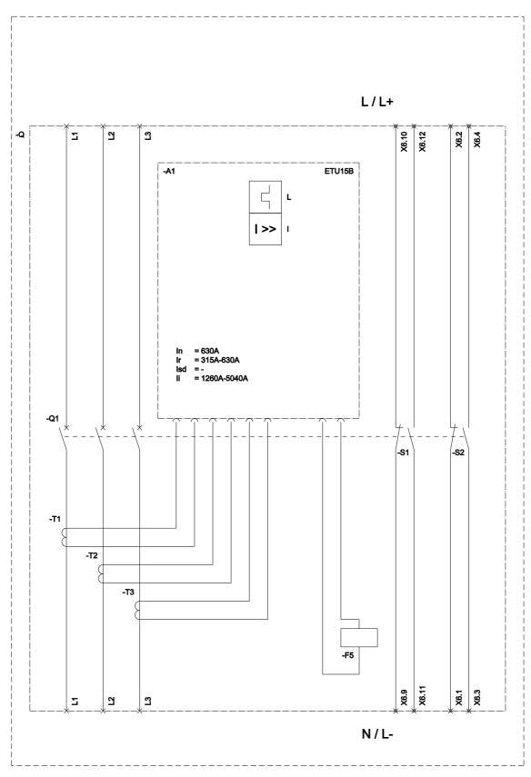
L (Long Time Delay / Überlastschutz); I (Instantaneous / Kurzschlussschutz, unverzögert); F5 (Maglatch for trip unit / Auslösemagnet); S1 - S8 (Auxiliary switch / Hilfisschalter);
